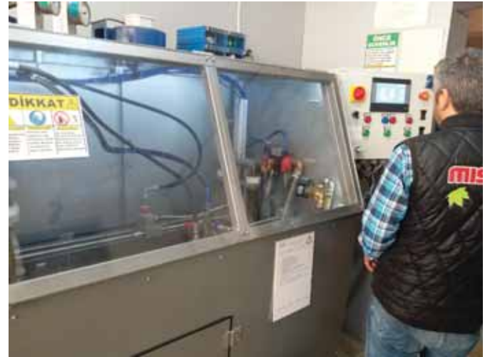
Flexible Çelik Bağlantı Yüksek Basınç Test Makinası Braided Flexible Hose Tension and Pressure
